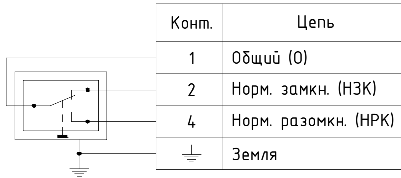
Рисунок 4б. Электрическая схема расключения разъема реле давления
