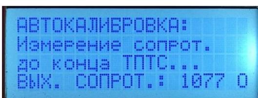
Измерение сопротивления термокабеля
