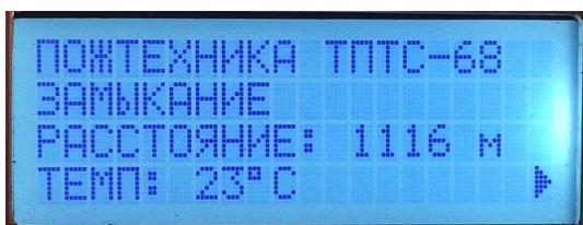
Индикация короткого замыкания
