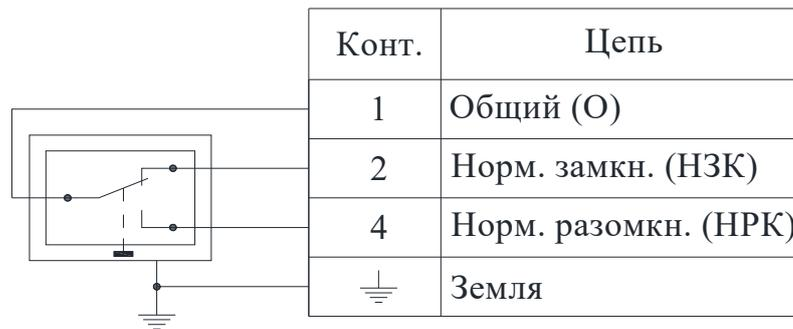
Рисунок 3б. Электрическая схема расключения реле давления
